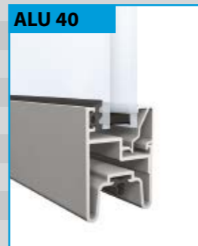
ALU 40 Panorama-Tor 40 mm Plexiglas-Doppelscheiben Optical 20 mm (4-12-4 mm)
