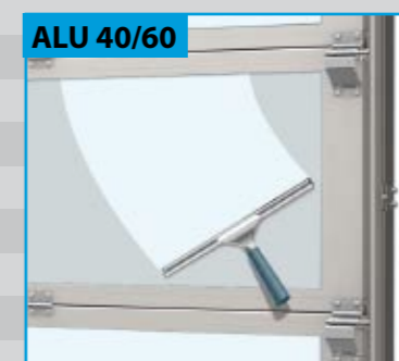
ALU 60 Panorama-Tor 60 mm Plexiglas-Dreifachscheiben Optical 40 mm (4-14,75-2,5-14,75-4 mm)
