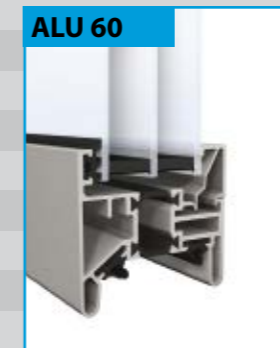
ALU 60 Panorama-Tor 60 mm Plexiglas-Dreifachscheiben Optical 40 mm (4-14,75-2,5-14,75-4 mm)
