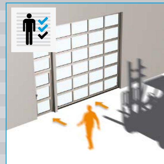
Türen und Tore für Menschen und Güter getrennt, aber in der gleichen lichten Öffnung.
